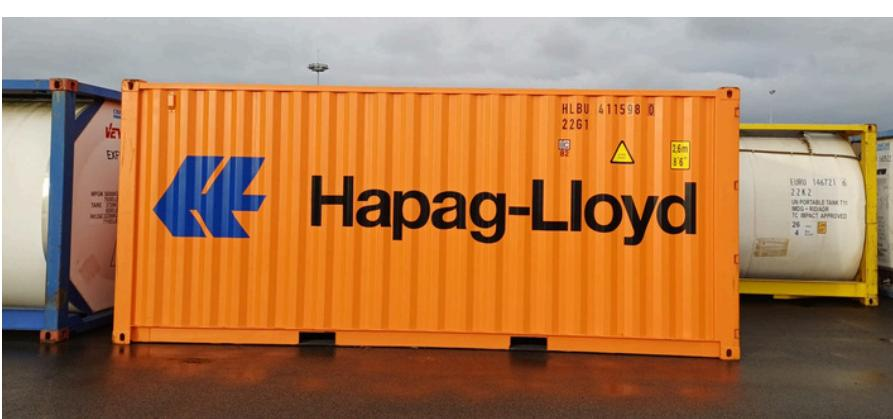
Le modèle de base est le 20' appelé EVP (Equivalent Vingt Pieds) aux dimensions de 6,05m x 2,44m et 2,60m de hauteur. Plusieurs déclinaisons existent notamment le 40' avec une longueur double et une variante high cube qui fait 2,90 m de haut.
