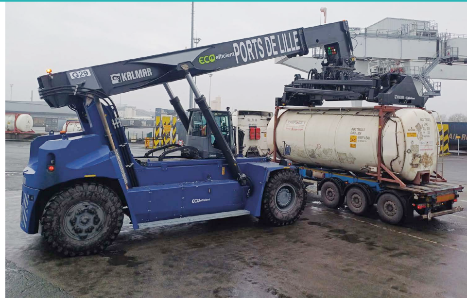
Reach stacker à transmission hybride, terminal de Lille.
