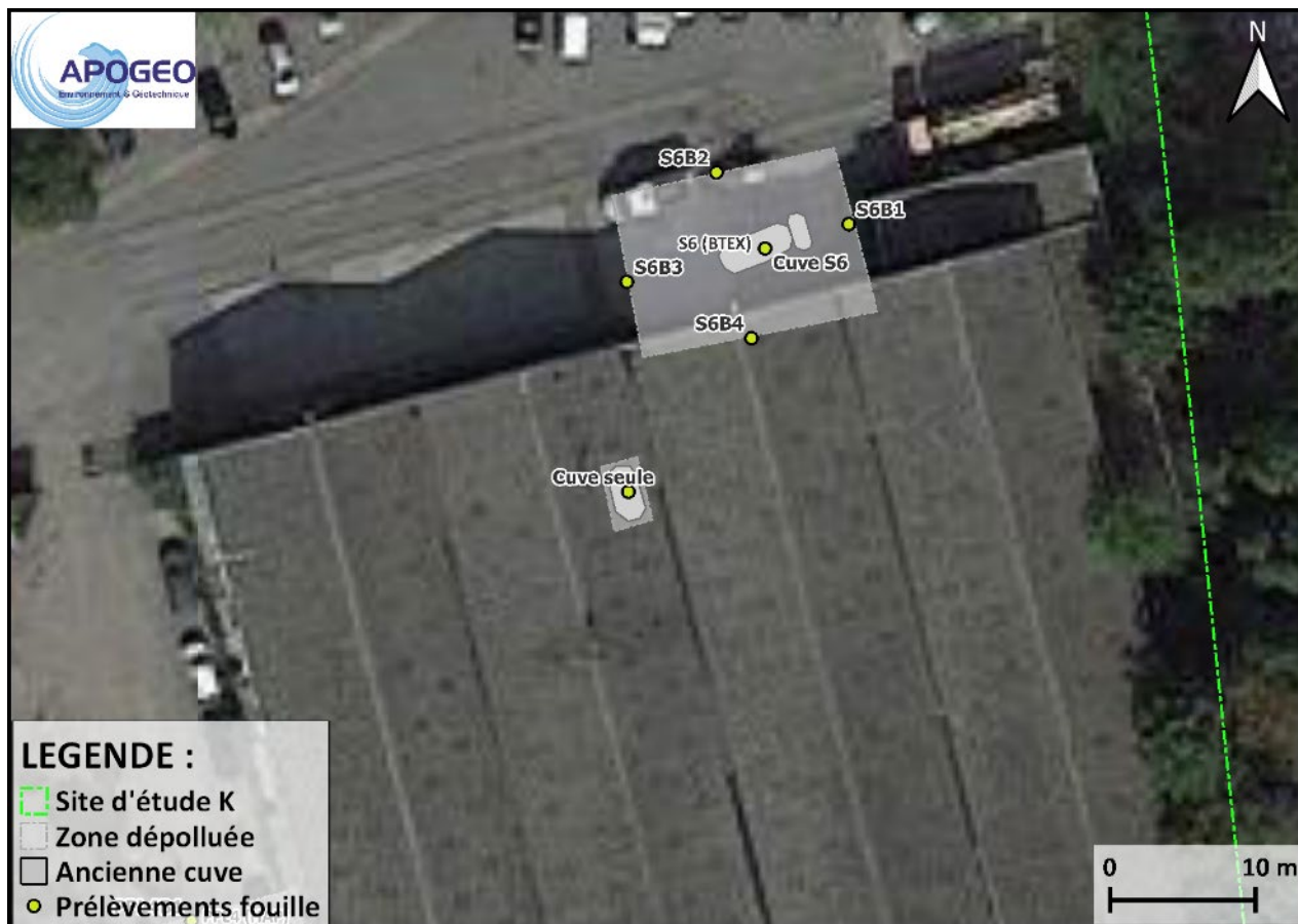
Figure 28 : Localisation de la zone dépolluée au droit de la cuve
