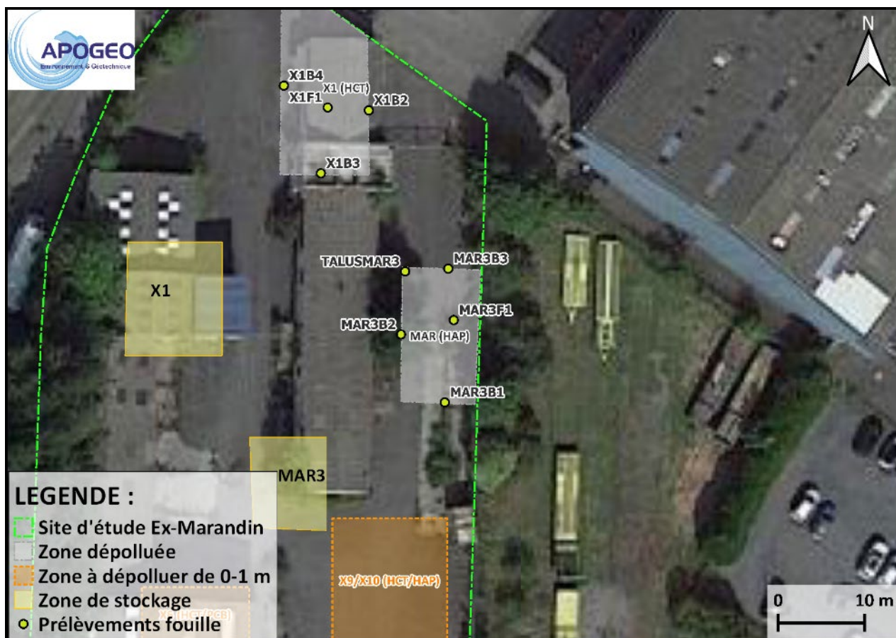
Figure 39 : Localisations des prélèvements au droit de la fouille MAR3
