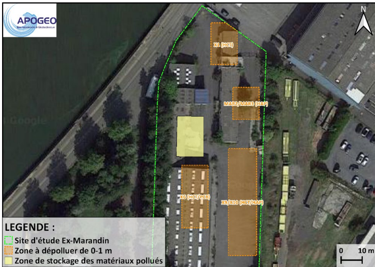
Figure 15 : Localisation de la nouvelle zone de stockage des matériaux pollués sur le site Ex-Marandin
